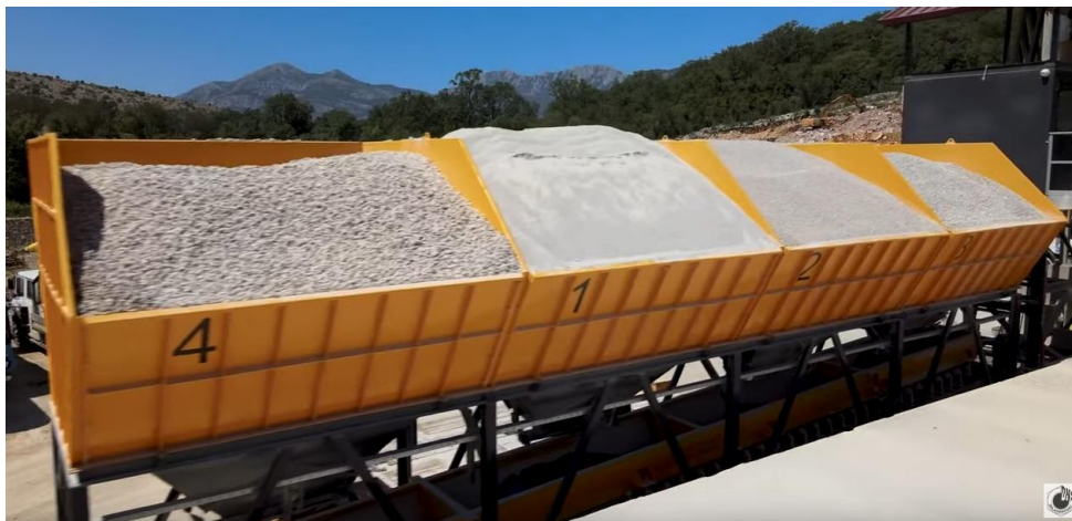
Slika 14. Koševi za skladištenje mineralnog agregata
