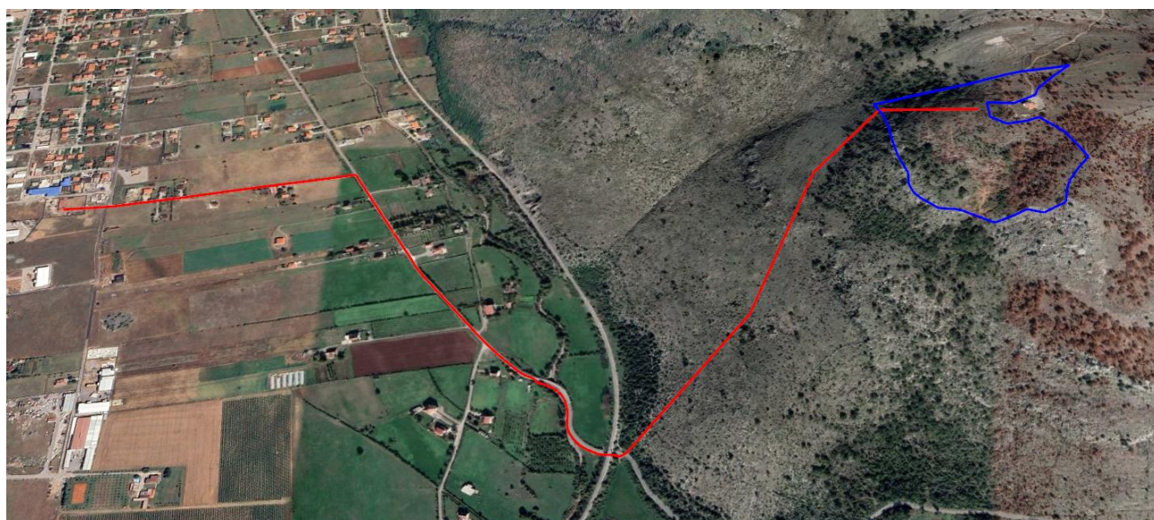
Slika 2. Lokacije solarne elektrane (označena plavom linijom) i trasa podzemnog kabla (označen crvenom linijom) sa užom okolinom
