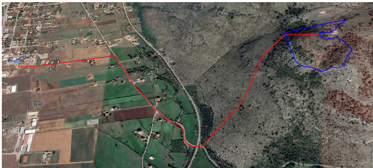
Slika 2. Parcele na kojoj će biti izgrađena solarna elektrana (oivičena plavom linijom) i trasa podzemnog kabla (označena crvenom linijom) sa užom okolinom
