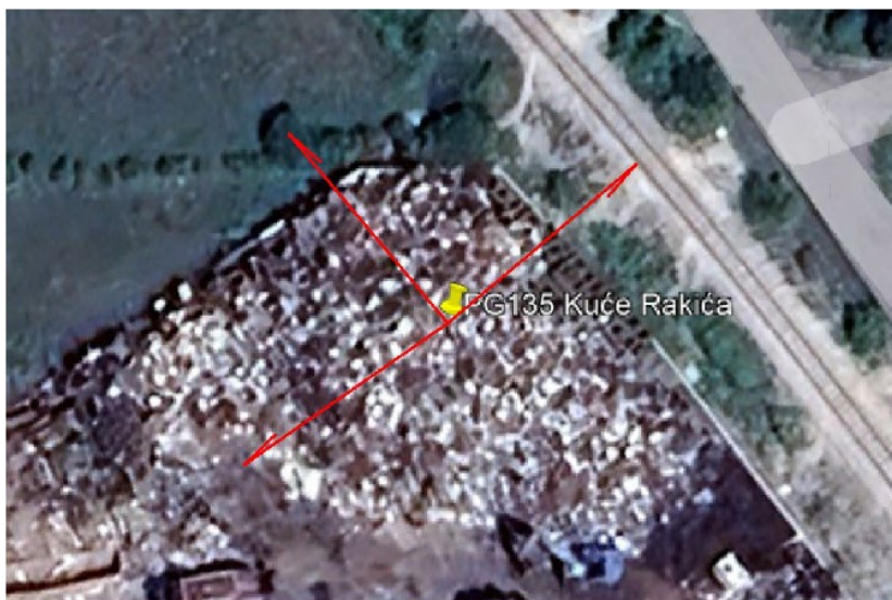
Slika 5.1. Pozicija antenskog stuba sa prikazanim azimutima Mtel antena, graničnom zonom i okolnim objektima
