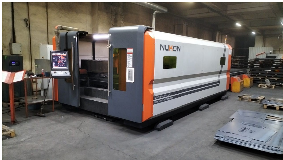
Sl.3.4.2. Mašina za lasersko sječenje cijevi i profila
